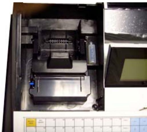
Pulsar la palanca azul para levantar el retenedor de papel del tiquet.
